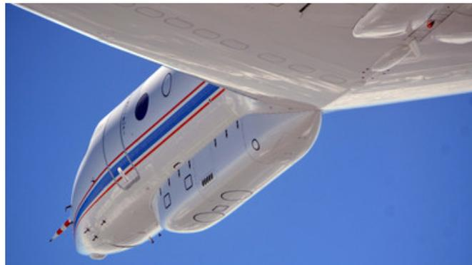
Abb. 2: "Belly Pod" unter dem Rumpf von HALO. Er enthält die Radiometer, das Radar und den Laser, mit denen die Profile während des Flugs gemessen werden. (Quelle: DLR)
